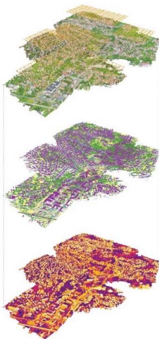
Slika 2. Prikupljanje podataka o oblaku tačaka na terenu pomoću drona na lokalitetu VI Transversale korištene za klasifikaciju zona i simulacije toplinskog otoka/dnevnog svjetla
